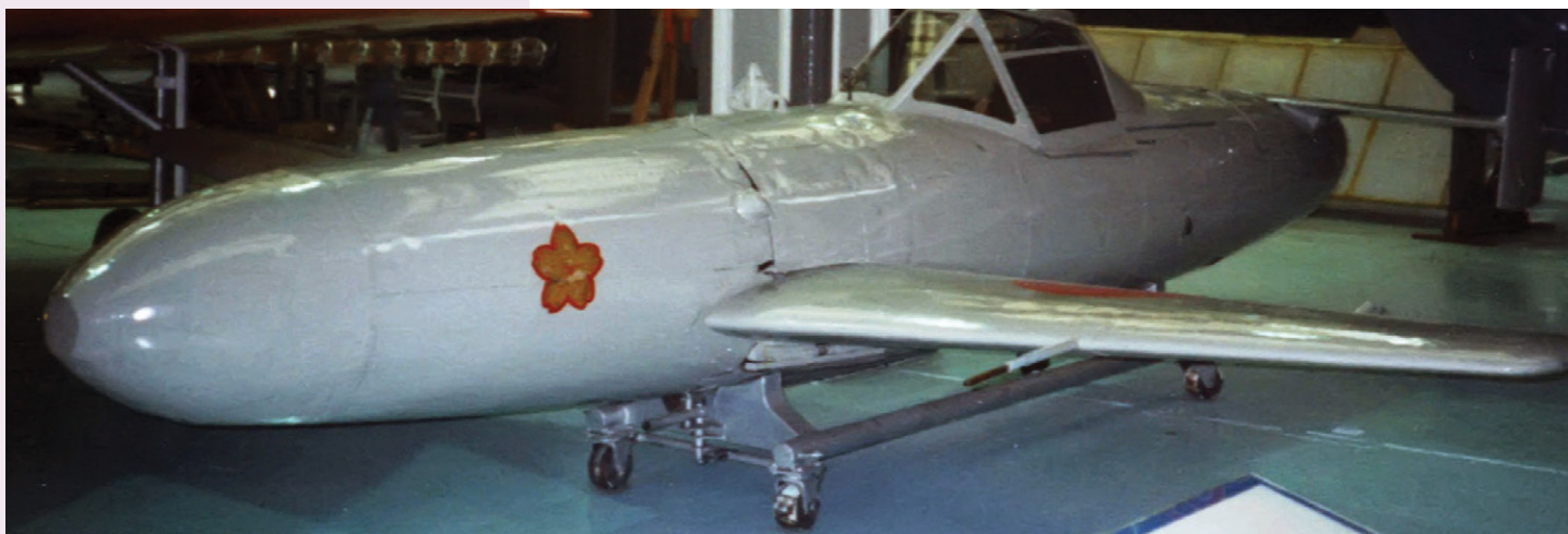
Fig. 3. Yokosuka MXY-7 Ohka (Floare de cireș), avion-bombă realizat special pentru atacurile kamikaze
